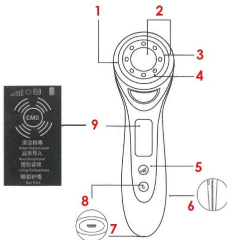
1. Anneau de fixation en coton de maquillage; 2. Tête de massage ; 3. Abat-jour ; 4. Lumières LED ; 5. Ajustement de la température ; 6. Bande d'induction ionique ; 7.USB ; 8. Bouton d'alimentation/commutateur de mode ; 9. Écran d'affichage des opérations.
